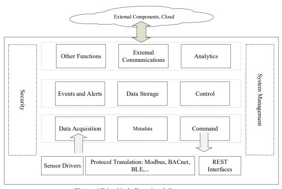
Figure 4 Edge Node Functional Components
